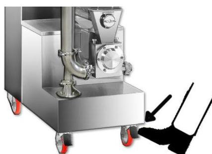
Spostare la macchina tenendola con le due mani e facendola muovere avanti o indietro - le ruote anteriori sono piroettanti e le ruote posteriori sono fisse.
